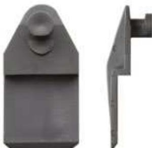
Переходной крюк имеет выступ с защелкой, устанавливаемый в отверстие для подвеса соединительной коробки. Переходной крюк фиксируется на соединительной коробке, заводится за поперечную рейку и обеспечивает таким образом крепление соединительной коробки в опоре.
